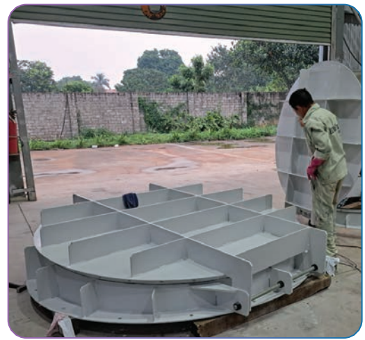
Van cửa lật sản xuất tại Nhà máy của WESTERNTech Việt Nam
