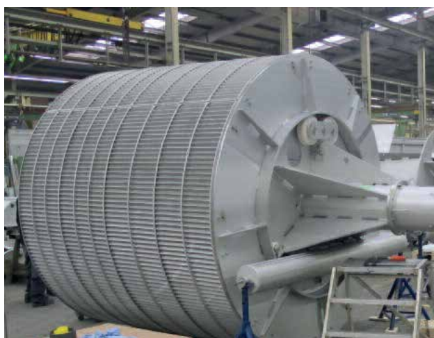
HUBER perforated Plate Screen ROTAMAT® STAR , đường kính 2600mm, lỗ 1mm
